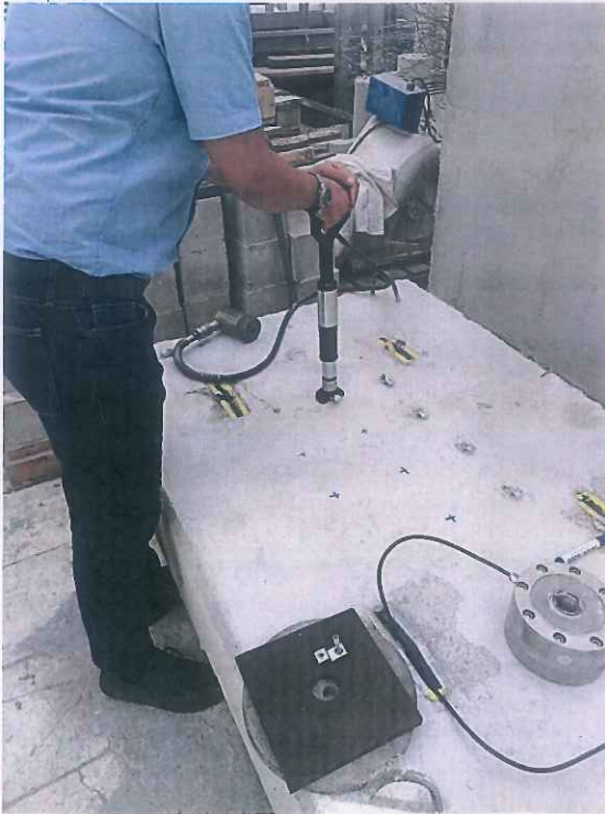
Resim 2. Çekme (Pull-out) yükleme sistemine ait resimler.
