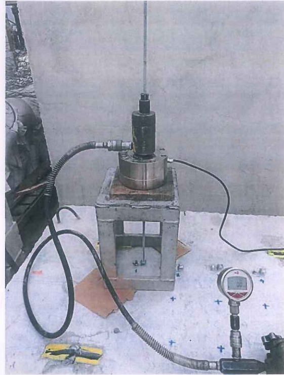
Resim 2. Çekme (Pull-out) yükleme sistemine ait resimler.
